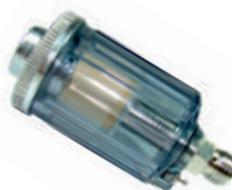
Высокопористый фильтрующий элемент предназначен для дополнительной очистки сжатого воздуха от водно-масляного аэрозоля и частиц пыли размером от 10 микрон. Фильтр устанавливается на ручку краскопульты.
