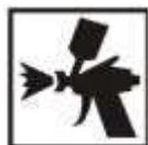
Наносить с помощью пистолета-распылителя, оборудованного соплом  $\varnothing 1,4$ - $\varnothing 1,8$  мм при давлении воздуха от 3,0 до 5,0 бар.
