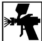
Наносить пистолетом-распылителем, оснащенным соплом  $\varnothing 1,6$ - $\varnothing 1,8$  мм при давлении воздуха от 2,0 до 2,5 бар.
