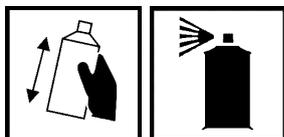
Содержимое упаковки хорошо перемешать, встряхивая емкость в течение 2-3 минут. Выполнить пробное распыление. Обработанную поверхность равномерно покрыть распылением с расстояния 20-30 см.
