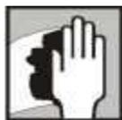
Перед нанесением шпаклевки, обрабатываемую поверхность следует очистить от пыли и обезжирить растворителем W900 или WB900.
